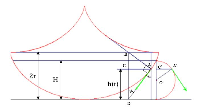
rを生成円の半径とし、円上の質点を H 2r の高さから回転させる。h(t)を時間 t における質点の高さとし、その点における速さを V(t)とする。h(0)=H とする と、速度の大きさはエネルギー保存則によって決定される。
