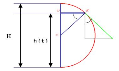
次にサイクロイド上の質点の運動をひとまずおいて、速度 $V_{vert}$  (t)、初期条件 h(0)=Hの直線運動h(t)を考えればよい。 $h(t_1)$ =0 となる値t= $t_1$ を見つけねばならない。これは典型的な微分方程式の問題であるが、ホイヘンスはある巧妙な方法を思いついた。彼は今 1 つの補助運動を考察した。質点が直径(2rではなく)Hの円のまわりを速度Wで頭頂点から出発し、一様に移動するとする。時間tでは質点は高さh(t)の点A'にある。この点における速度の垂直成分を求めることは困難ではない。実際、
