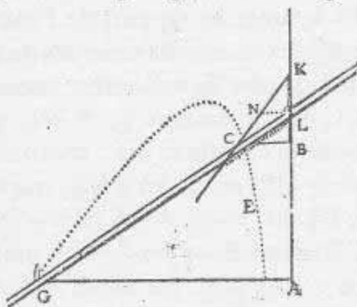
この曲線を描くのに使う器具で、平面 CNKL を限るものが直線 CNK でなく、この双曲線、あるいは第 1 類の他の何らかの曲線であるようにすれば、この線と定木 GL との交わりは、双曲線 EC のかわりに、第 2 類に属する他の曲線を描くであろう。たとえば、CNK が L を中心とする円であれば、古代人の第 1 コンコイドが描かれるであろうし、KB を直径とする放物線であれば、私が先ほどパプスの問題に関して最初の最も単純な線と言ったもの、つまり位置に関して与えられた直線が 5 本しかない場合の〔或る〕線が描かれるのである。しかし、平面 CNKL を限るものが第 1 類のこれらの線でなくて、第 2 類の曲線の 1 つであるならば、それによって第 3 類の線のひとつが描かれるであろうし、第 3 類の線のひとつが使われるならば、第 4 類の線のひとつが描かれ、以下同様にどこまでも進むであろう。
