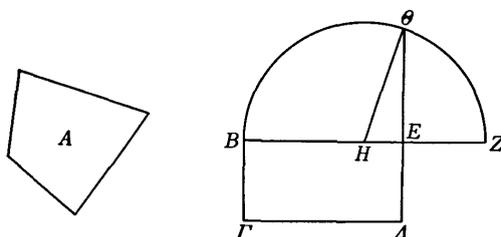
直線図形  $A$  に等しい直角平行四辺形  $B\Delta$  がつくられたとせよ。そうすればもし  $BE$  が  $E\Delta$  に等しければ、命じられたことはなされたことになるであろう。なぜなら正方形  $B\Delta$  が直線図形  $A$  に等しくつくられたから。もし等しくなければ、 $BE$ ,  $E\Delta$  の一方が大きい。 $BE$  が大きいとし、 $BE$  が  $Z$  まで延長され、 $EZ$  が  $E\Delta$  に等しくされ、 $BZ$  が  $H$  で2等分され、 $H$  を中心とし、 $HB$ ,  $HZ$  の一を半径として半円  $B\Theta Z$  が描かれ、 $\Delta E$  が  $\theta$  まで延長され、 $H\theta$  が結ばれたとせよ。
